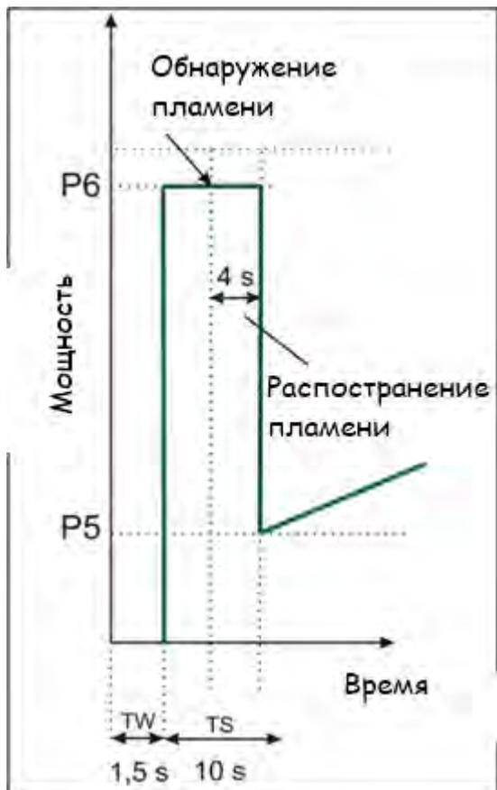
При наличии запроса на тепло, горелка включается на мощности определенном параметром **P6**.
